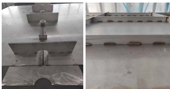
附图四十一:按照要求定位焊接
