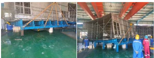
附图五十六:水平托架吊装水箱防止变形
