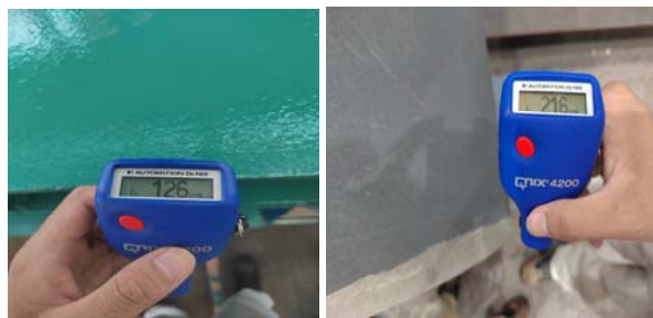
附图四十九：实测油漆厚度不满足设计要求
