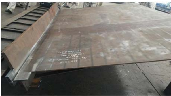
附图四十五:先对接焊缝后组装
