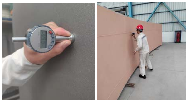
附图二十七:喷砂检查 附图二十八:油漆检查
