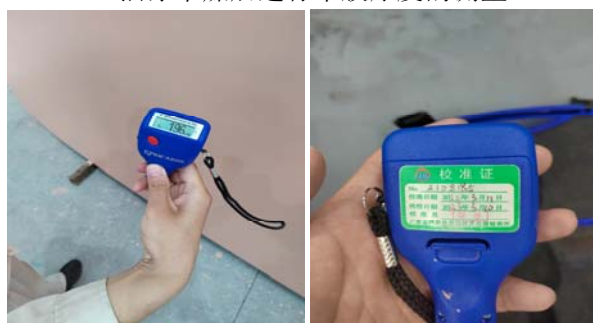
附图五十：实际厚度符合设计要求，漆膜测厚仪标定后使用
