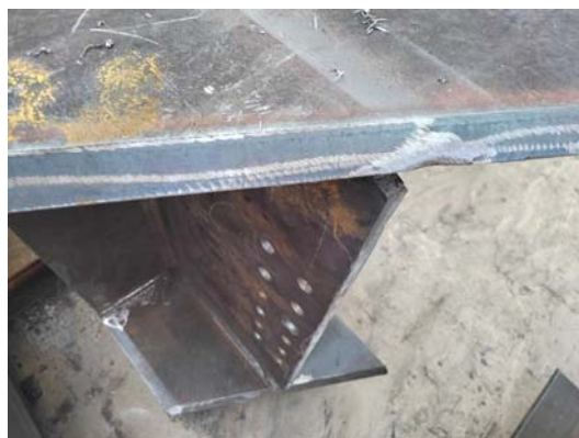
附图三十七:坡口切割平整
