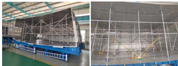
附图五十五:内部支撑防变形
