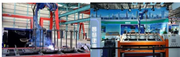
附图五十二：核电预埋件自动焊接机器人
