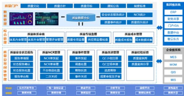
图41 全生命周期质量管理平台（QMSS）系统构架
