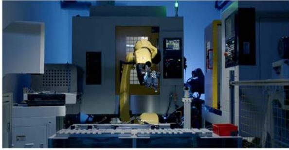
图12 智能自动化试样加工中心
