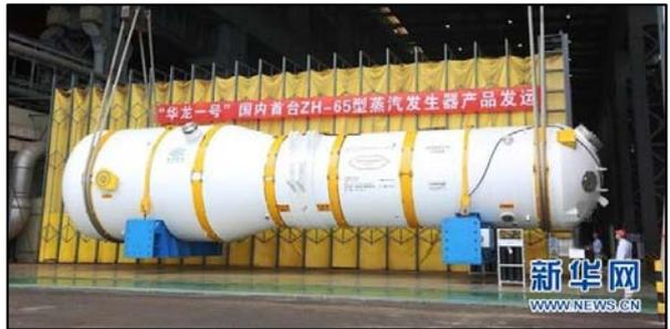
图43 全球首台“华龙一号”ZH-65型蒸汽发生器
